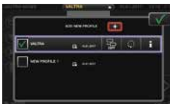
Operatoriams ir padargams skirti profiliai lengvai pakeičiami iš bet kurio ekrano meniu. Visi nuostatų pakeitimai bus įrašomi į pasirinktą profilį.
